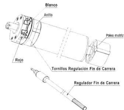
**Nota:** Tener en cuenta que la regularización del fin de carrera puede ser diferente dependiendo de la posición del motor (izquierda/derecha).
